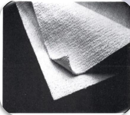
Tela de asbesto con inserción de alambre de latón impregnada con cemento de hule natural resistente a altas temperaturas.
